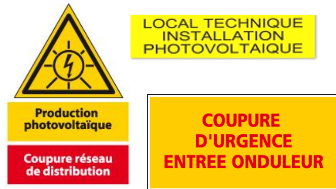
Figure 83 : Exemples de signalisation sur une installation photovoltaïque (Source : www.etiquette-photovoltaïque.com )
